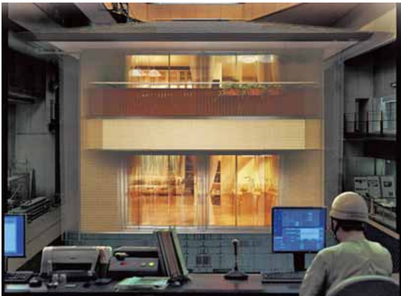
各社、実際に使われる素材・材料や工法によるモデルを用いて、大地震並みの振動での実験を繰り返し強度や耐久性を確認
