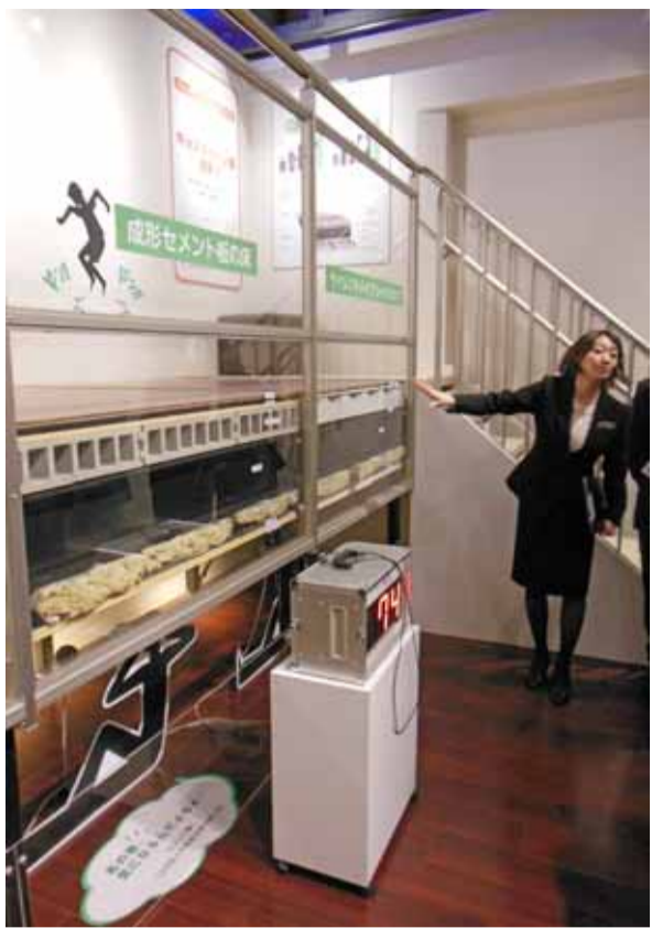
重量床衝撃音と軽量床衝撃音の両方で遮音性の違いを検証（大和ハウスの試験施設）
